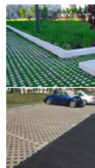
Exemples de dalles et pavés semi-perméables
